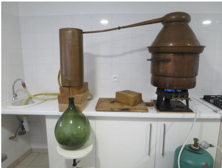
Figure 17 : Alambic en cours de distillation pour la production d'hydrolat Source personnelle
