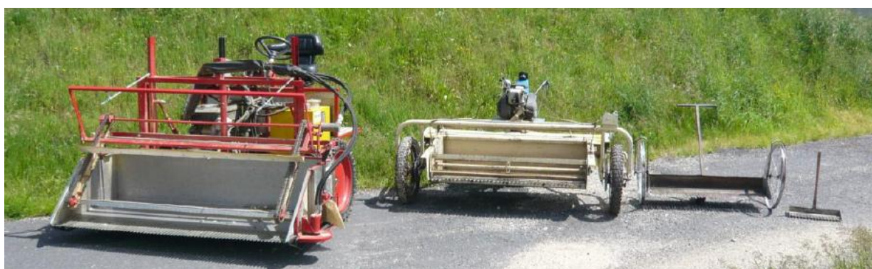
Figure 26 : Evolution (de droite à gauche) du matériel utilisé pour la cueillette de narcisse et jonquille dans le Massif central Source : Grégoire Mähler
