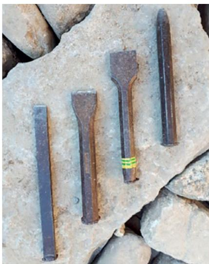
De gauche à droite : un ciseau plat, deux chasses, une pointerolle, outils au carbure de tungstène pour la taille de pierres dures.
